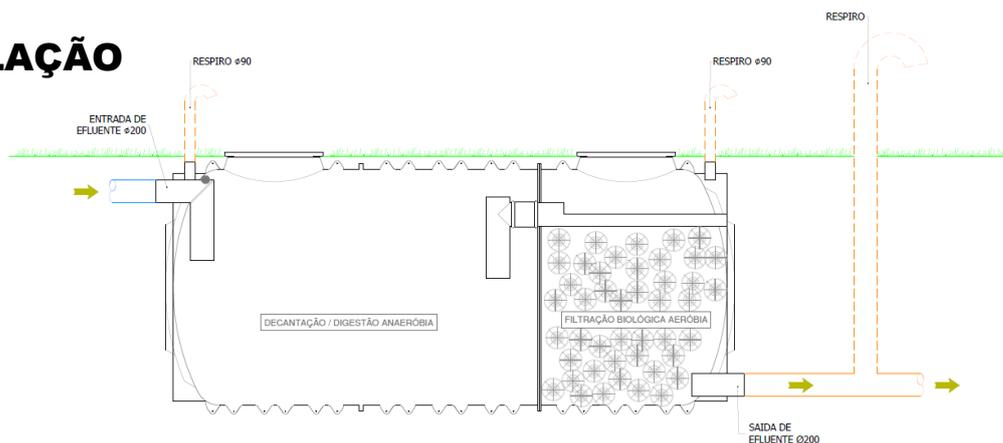
A instalação dos da Fossa Biológica ECODEPUR® BIOFIX deverá seguir as recomendações para a Instalação dos Reactores/Reservatórios em Polietileno (Ø 2.190 ou Ø2.980) , que são fornecidas com o Catálogo do Produto.
